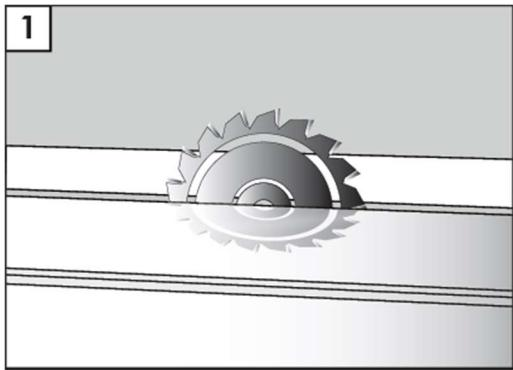
1. Une scie circulaire avec engrenages doit être utilisé lors de la découpe.
