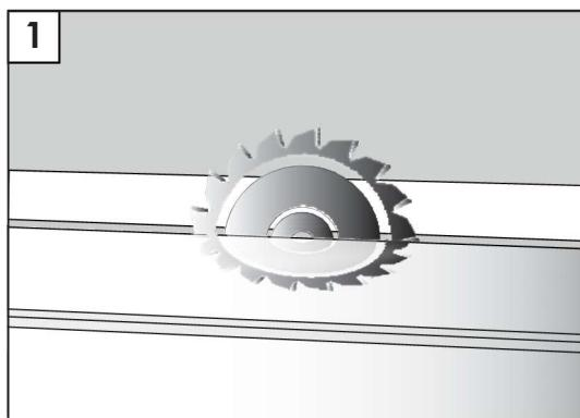
1. При резке следует использовать дисковую (циркулярную) пилу.
