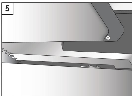
5. Daha iyi sonuç almak için panel kesiminde çizicili 'jumpingli' testere kullanılmalıdır.
